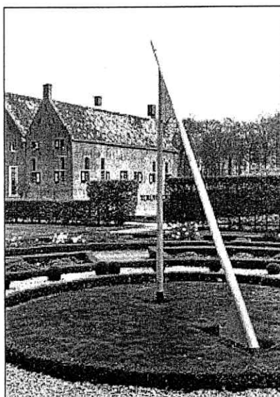
Fig. 8. Parkzonnwijzer in de tuin van de Menkemaborg in Uithuizen (NL) met ondersteunde poolstijl. De uurpunten worden gevormd door buxus-bolletjes, het 12-uurs punt heeft er twee.
